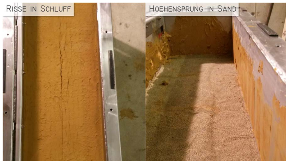
Abb. 75 Risse in Schluffschicht
