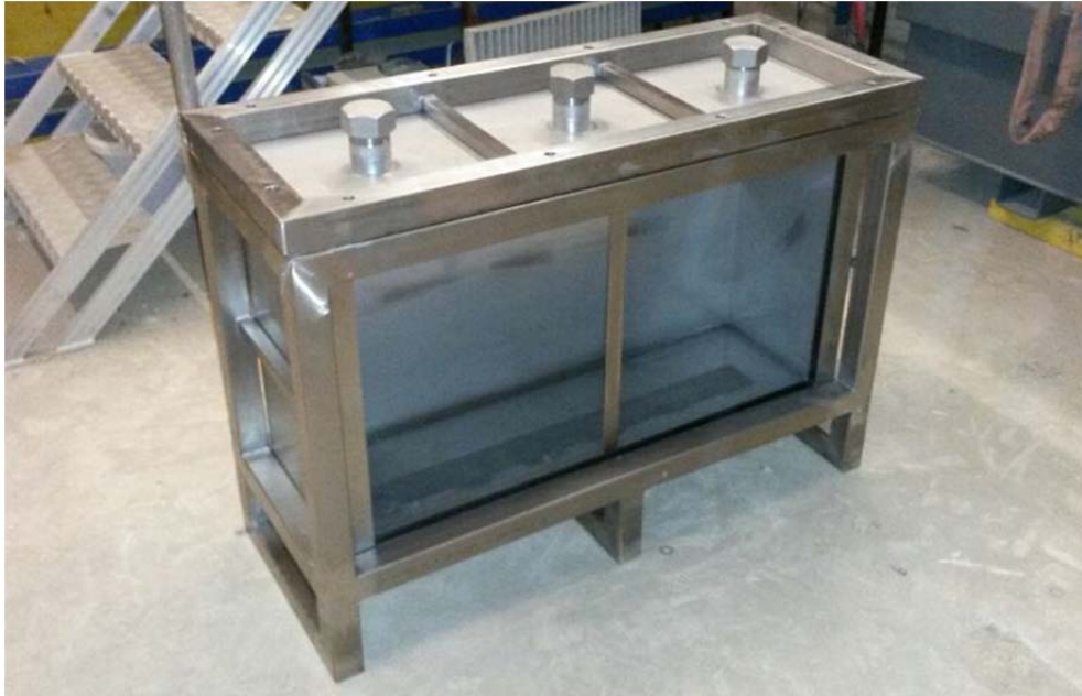
Abb. 44 Versuchsbehälter im „Rohzustand“
