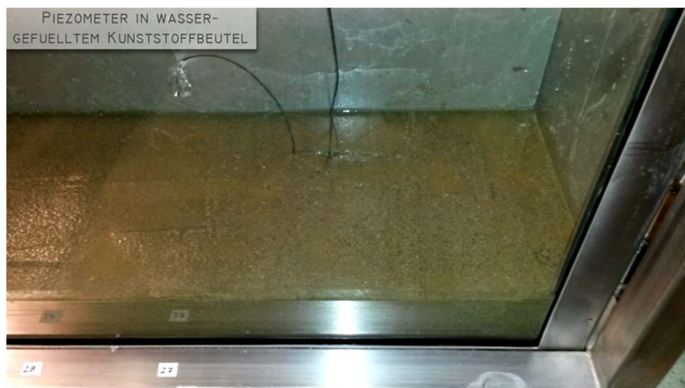
Abb. 66 Einbau Piezometer, Versuchsdurchgang 1
