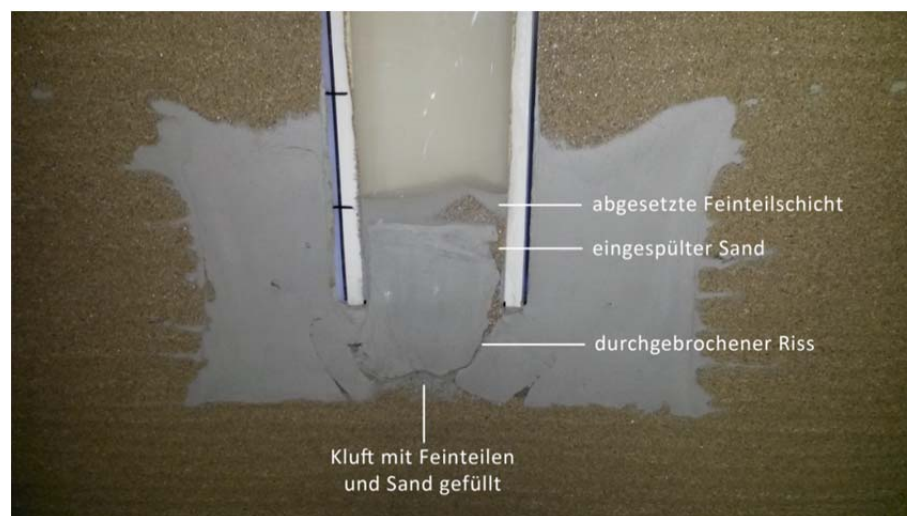
Abb. 37 Versuch Schluff, Endzustand
