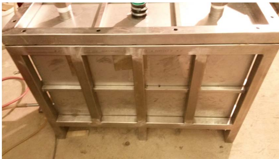
Abb. 47 Verstärkungen zur Reduktion der Verformungen
