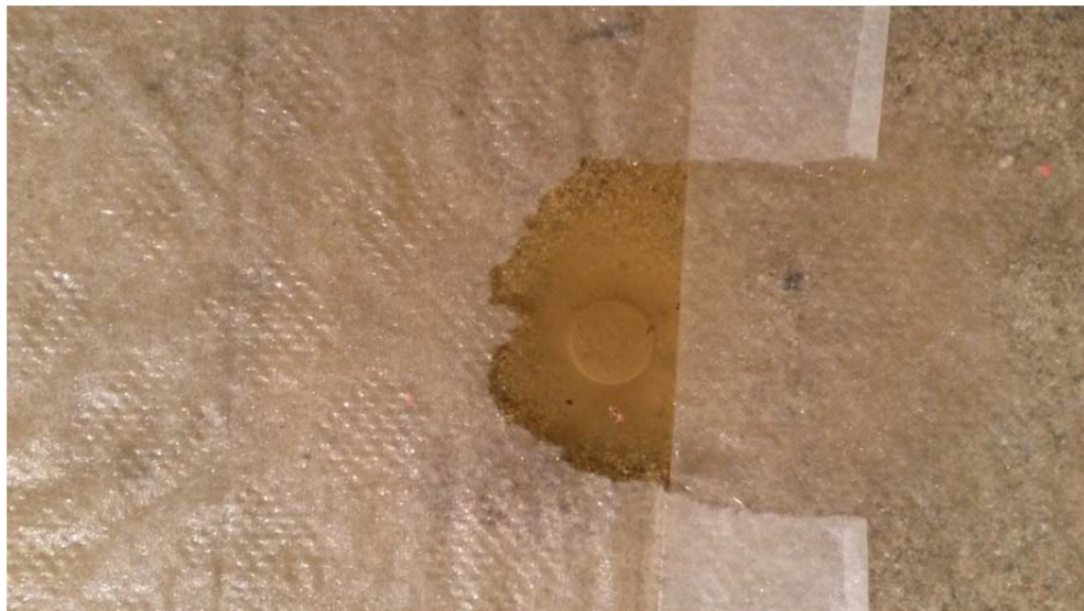
Abb. 77 Einbau Piezometer in Grenzschicht Sand - Schluff
