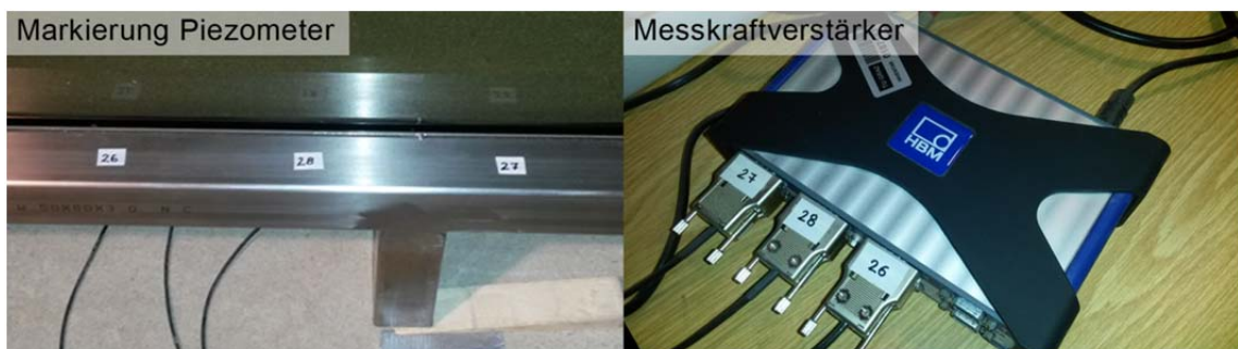
Abb. 50 Piezometeranschluss an Messkraftverstärker
