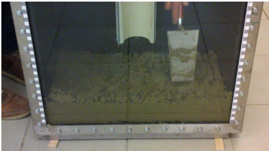
Abb. 24 Schichtweises Einbringen des Wasser-Sand-Gemischs
