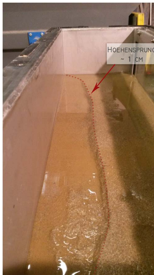
Abb. 69 Versagen der Bodenschicht nach Versuchsdurchgang 1
