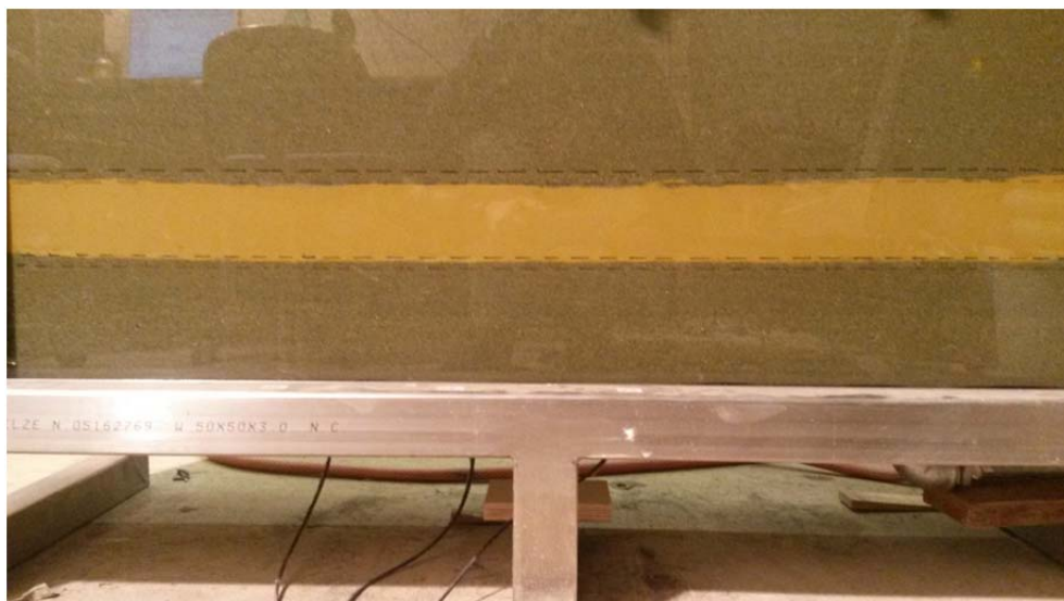
Abb. 79 Setzungen in Schluffschicht nach Konsolidierung
