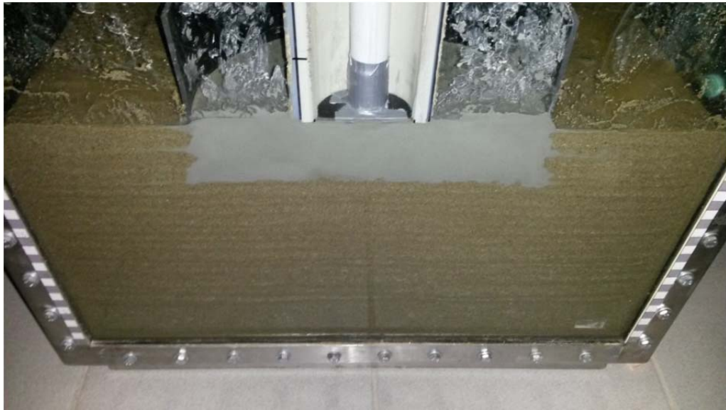
Abb. 25 Einbringen der Schluff-Linse mithilfe einer Gummischalung
