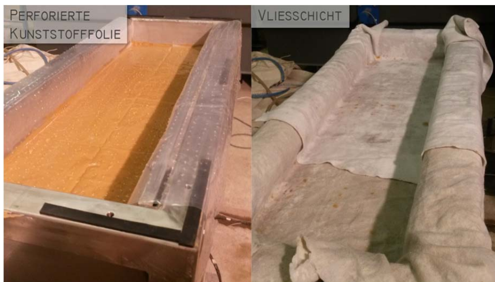
Abb. 71 Trennschichten für Konsolidierungsphase
