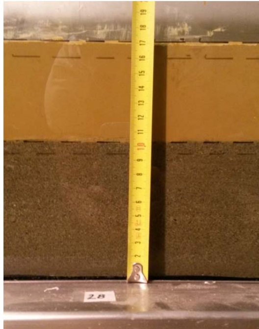
Abb. 78 Schichtstärke Schluff beim Einbau
