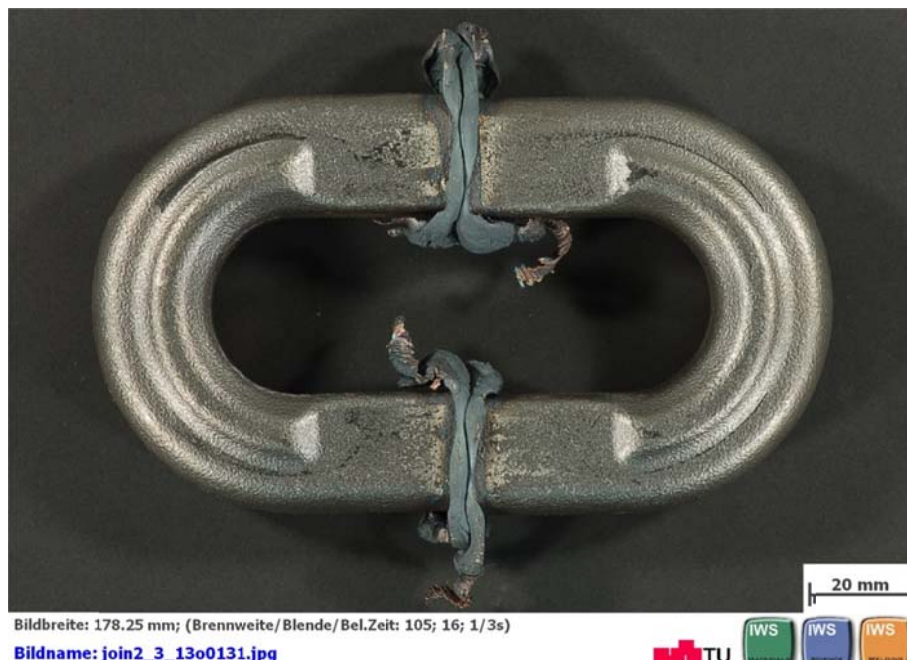
Abbildung 23 Linearreibgeschweißtes Kettenglied AISI 316L
