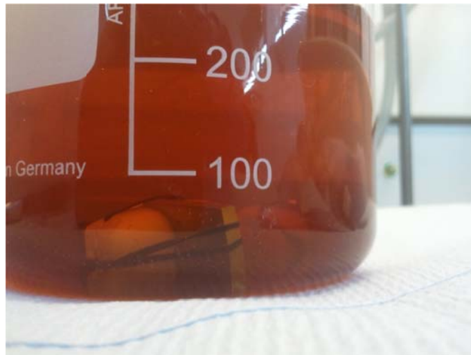
Abbildung 46 Versuchsaufbau chemischer Lochkorrosionstest - Methode B in Becherglas bei Raumtemperatur (Beispielbild)
