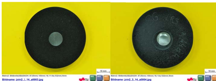
Abbildung 30 Probengeometrie für den DL-EPR-Test 1.4404 Vorder- und Rückseite
