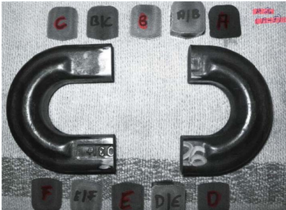
Abbildung A 3 Probeentnahme für elektrochemische Tests aus 1.4112 LRS: Kettengleid Nr 26; GW (A,D), WEZ (C,F), SN (B,E) [4]
