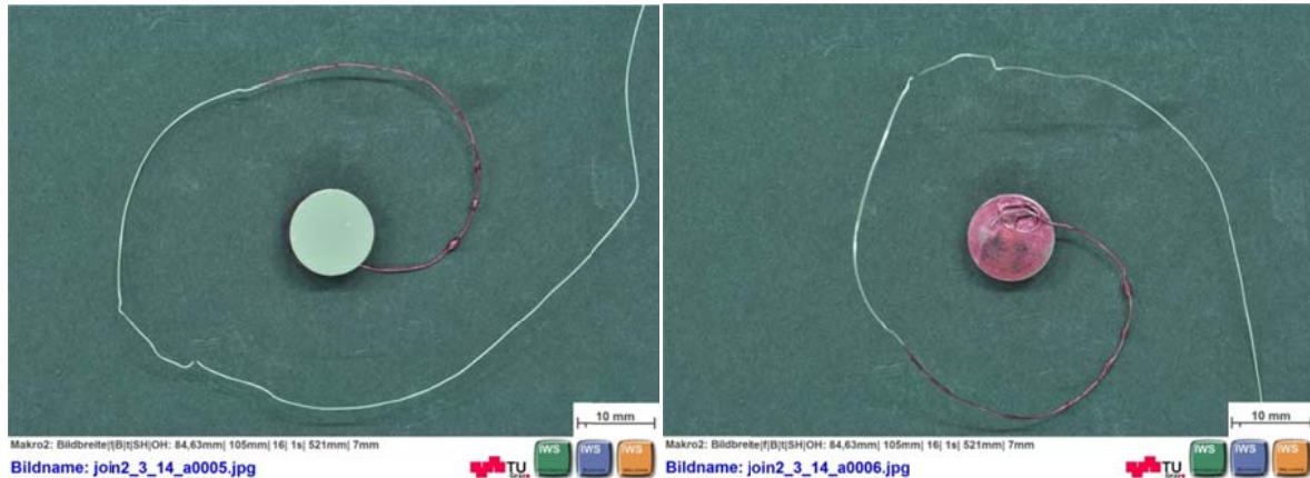
Abbildung 36 Proben für Lochkorrosionstest 1.4404 Schweißzonen mit angeschweißtem Draht; links: Prüffläche; rechts: Rückseite mit Lack beschichtet
