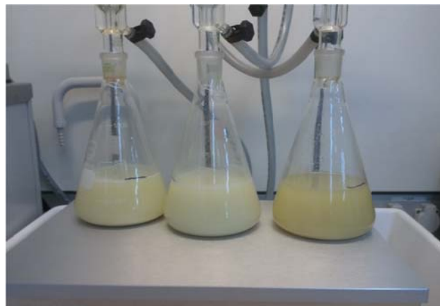
Abbildung 40 Streicher Test - Erlenmeyerkolben mit trüber Prüflösung (Eisensulfat noch nicht gelöst)
