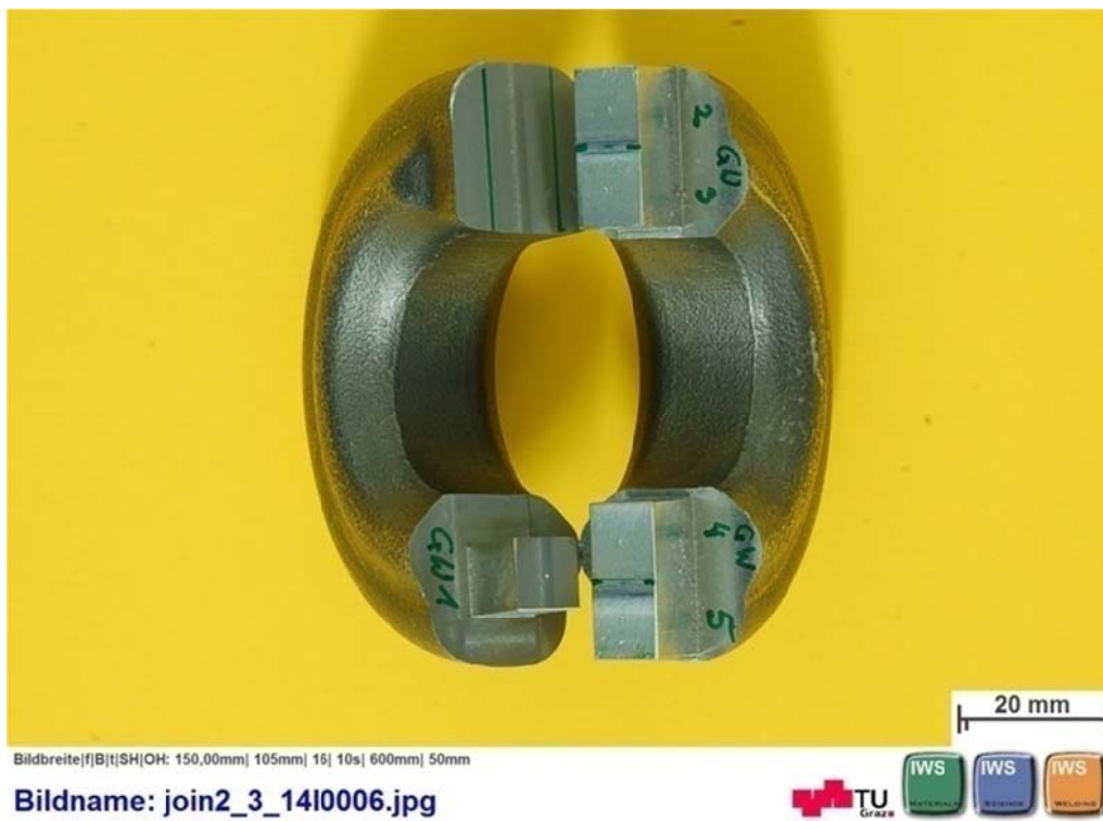
Abbildung A 4 Probeentnahme für chemische Korrosionstests 1.4404 LRS GW
