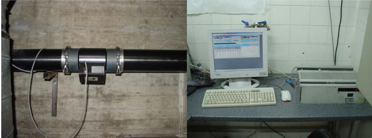
**Abbildung 5.3:** Sensyflow: Messwertaufnehmer (Messrohr) und Speise-/Auswertegerät (19“-Einschubgerät)
