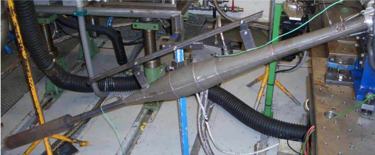
**Abbildung 3.22:** Auspuffanlage am Motorprüfstand
