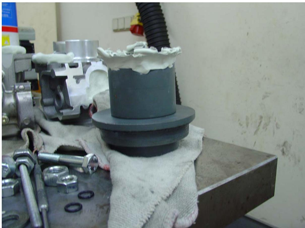
**Abbildung 8.7:** Adapter Strömungsprüfstand Durchflussmessung Zylinder
