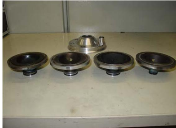
**Abbildung 4.7:** Zweiteiliger Zylinderkopf für die Prototypenerprobung
