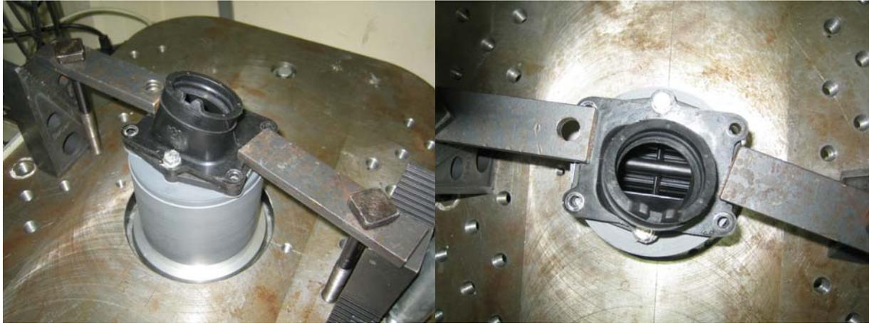
**Abbildung 5.9:** Membranvermessung am Strömungsprüfstand
