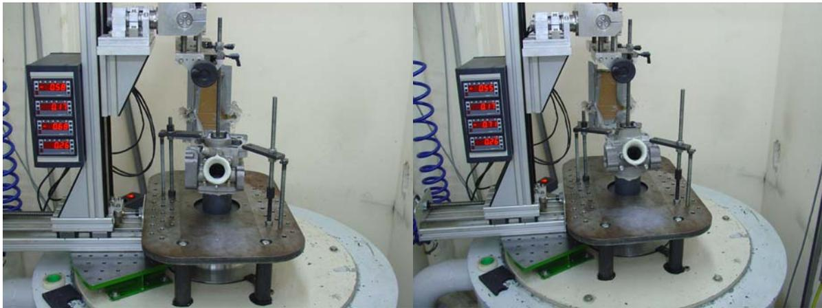
**Abbildung 5.10:** Versuchsaufbau Originalzylinder (links) und Prototypenzylinder (rechts)
