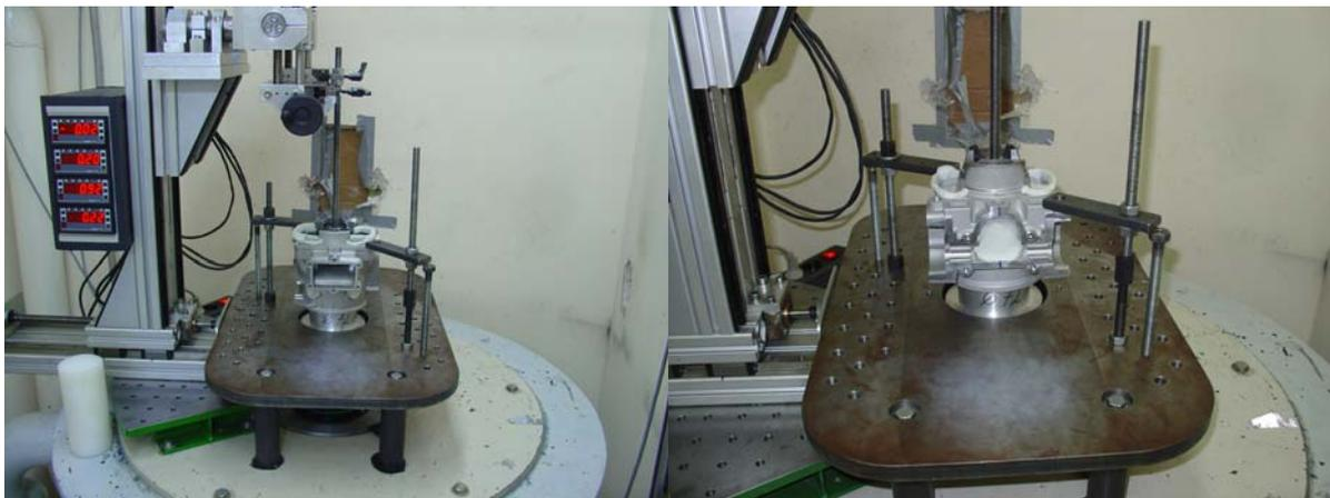
**Abbildung 5.18:** Versuchsaufbau Ladungsbewegungsmessung Originalzylinder (links) und Prototypenzylinder (rechts)
