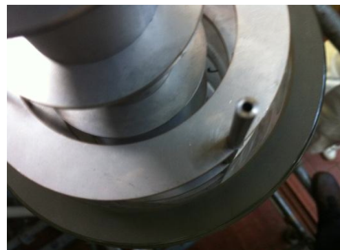
Abbildung 3.5: Versuchsaufbau: Spalt zwischen der Außenwand und Statorscheiben lässt die Kugeln zum Teil hindurch wandern.
