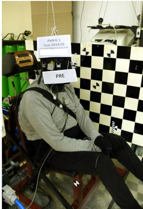
Abbildung 20: Ausgeführter Versuchsaufbau, PMHS auf Sitz platziert (Vehicle Safety Institute (VSI))
