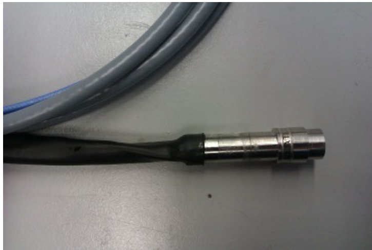
Abbildung 6.2: Fertiger Sensor mit Schutzabdeckung und Schrumpfschlauch zur Versiegelung.
