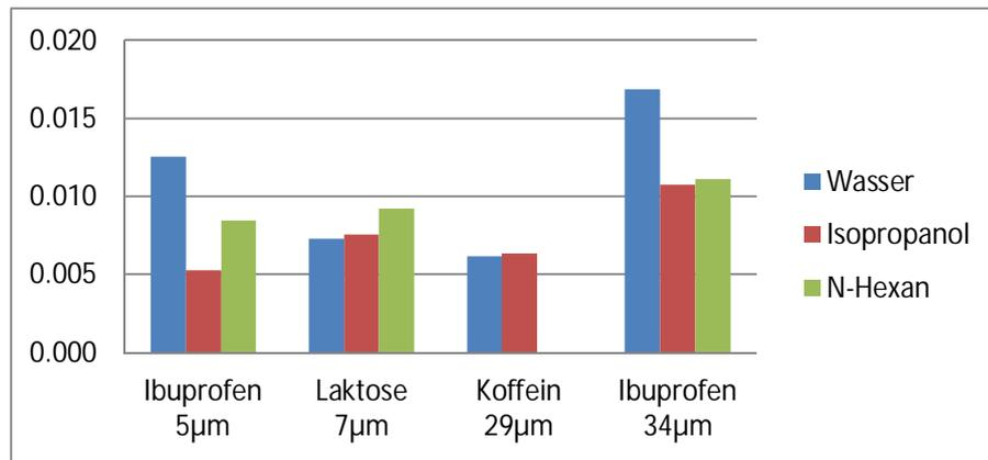
Abbildung 4 Kuchenhöhe [m] in Abhängigkeit des Lösungsmittelsystems
