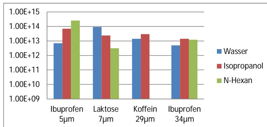
Abbildung 3 bezogener Kuchenwiderstand  $\alpha_H$  [ $1/m^2$ ] in Abhängigkeit des Lösungsmittelsystems
