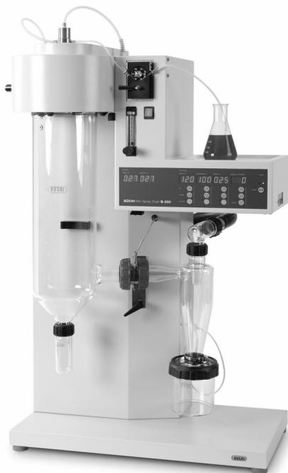
Figure 2 Büchi mini spray dryer B-290
