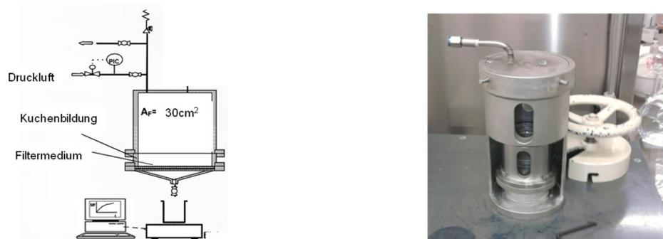
Abbildung 1 Druckfilternutsche nach VDI 2762 - Schematische Darstellung und Laboraufbau [2]
