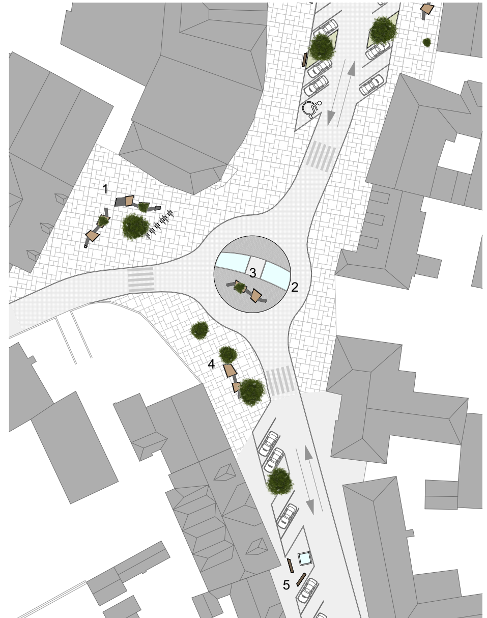
Abb. 48: Entwurf Kreisverkehr, M 1:750
