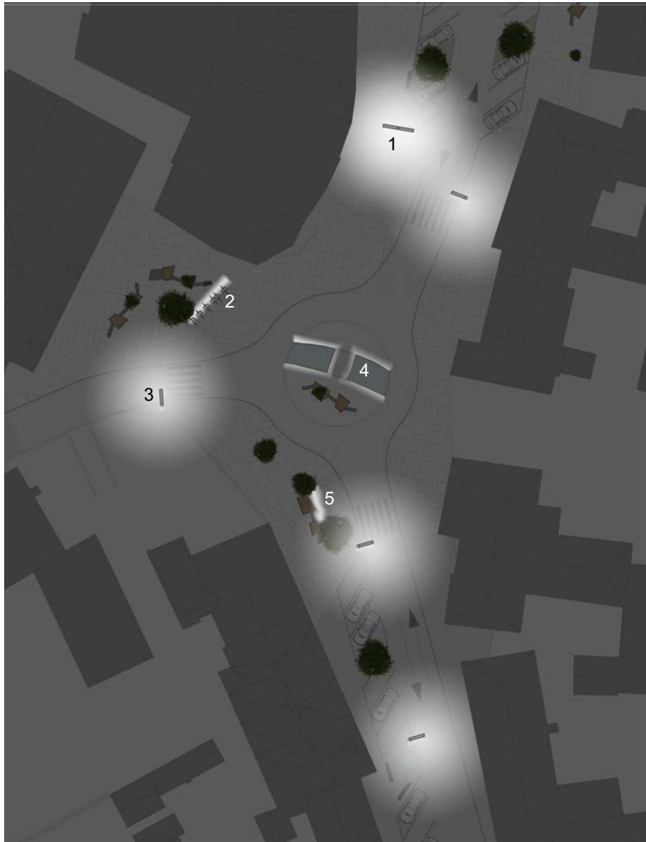
Abb. 10: Beleuchtungskonzept Kreisverkehr, M 1:750
