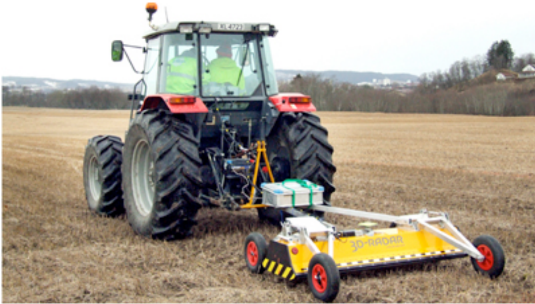
Abb. 6.3: Antennenarray-System der Firma 3d-Radar aus Norwegen mit einem Traktor gezogen (Foto: www.3d-radar.com )
