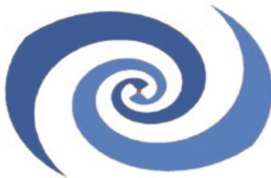
Abb. 4.8: flächig ausgeführte logarithmische Spiralantenne [18]
