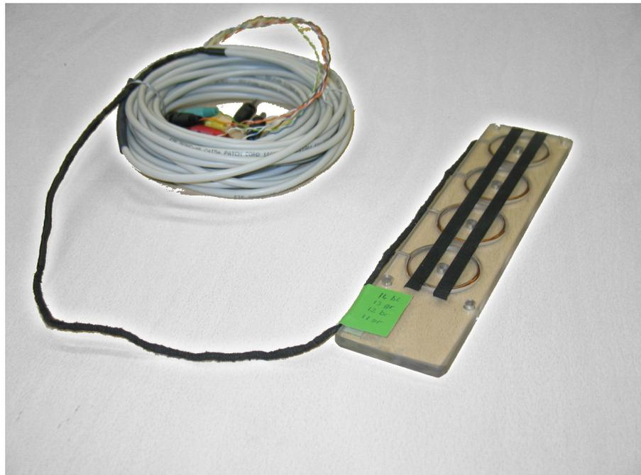
Abbildung 5.2.: Spule 11, 12, 13 und 14 in Arrayanordnung
