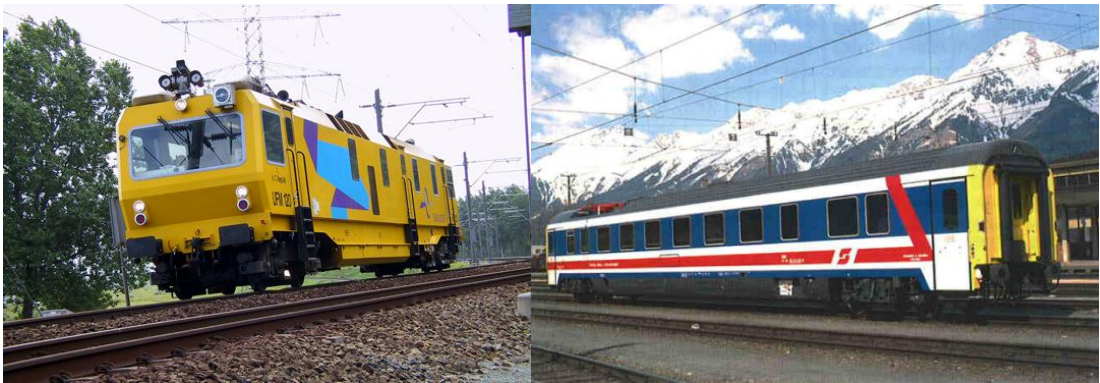
Abbildung 112 Messwagen als selbstfahrende Variante (links) [Plasser & Theurer 2013] oder angehängt an einen Zugverband (rechts) [Hanreich 2004]
