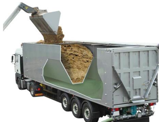
Abbildung 41 Wiese OptiTwin für dem gleichzeitigen Transport von Schüttgut und Flüssigkeiten. Eine Möglichkeit zur Kostenreduktion bei Gülletransporten.
