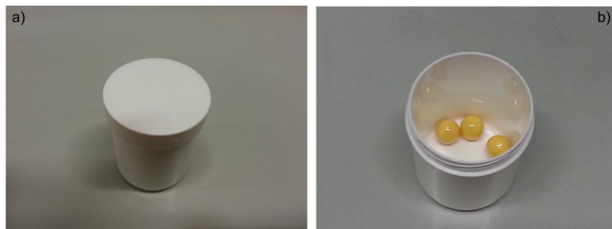
Abbildung 34: a) Einmalbecher verschlossen; b) Einmalbecher gefüllt mit 3 Kugeln ( \varnothing : 3cm ; \text{ZrO}_2 )
