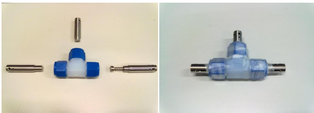
Abbildung 10: Swagelok-Zellen, mit der alle elektrochemischen Untersuchungen an mikro und nanokristallinem LTO durchgeführt wurden.
