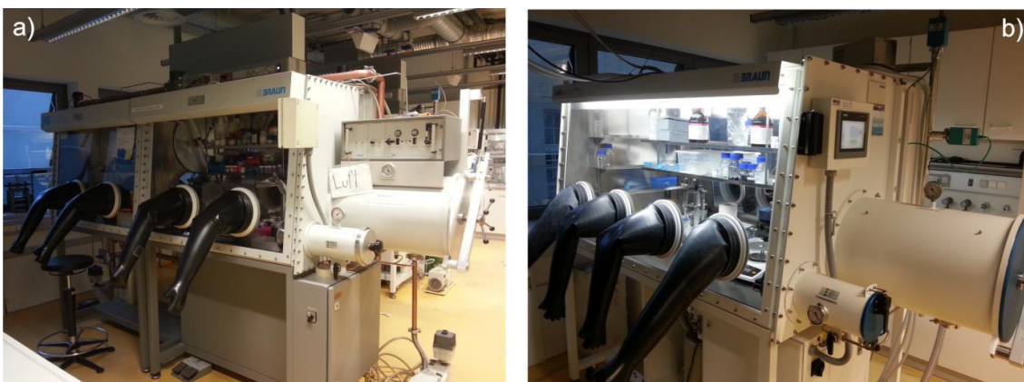
Abbildung 36: Gloveboxen der TU Graz, gefüllt mit Argon; Toleranzen \text{O}_2 und \text{H}_2\text{O} < 1 \text{ ppm} ; a) Mbraun Model 150B-G; b) Mbraun Model Labmaster Pro SP
