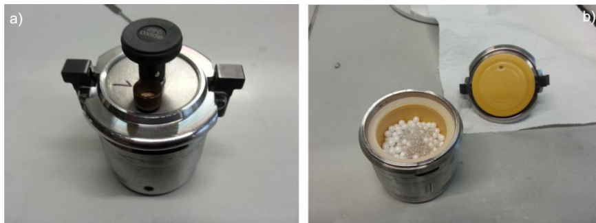
Abbildung 33: a) Mahlbecher aus \text{ZrO}_2 ; b) offener Mahlbecher gefüllt mit 180 Kugeln ( \varnothing : 5mm)
