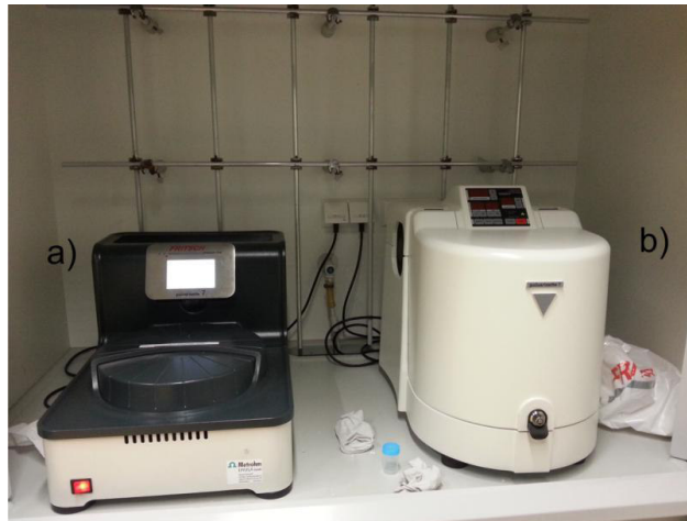
Abbildung 32: a) Pulverisette premium line (zum Nanostrukturieren); b) Pulverisette classic line (zum Homogenisieren von slurries )
