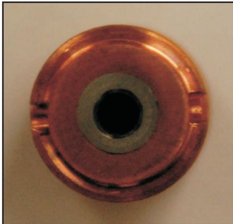
Abbildung 2: Die im Versuch verwendete Kathode: La als der Innenteil ummantelt von Kupfer [10].
