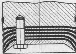
Abb. 944. Abdichtung eines Huberpennenkolbens für 5600 at.
