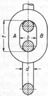
Abb. 904. Kette für Hebezeuge, DIN 672 und 671.
