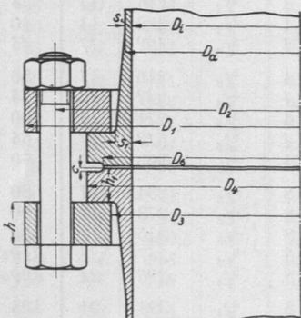
Abb. 694 und 695. Lose Flansche auf vorgeschweißten Bunden.
