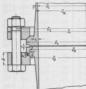
rührende Kraft von  $\frac{P}{i}$  kg in der Wandung, Abb. 691, läßt sich dann in eine senkrecht zur Anlagefläche des Flansches stehende Seitenkraft  $R$  und eine radial nach innen gerichtete  $Q$  zerlegen. Im Flansch wird Kraft  $R$  durch die radiale Kraft  $Q$  und diejenige in der Schraube  $\frac{P}{i}$  das
