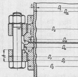
durch den Schwerpunkt  $S$  gehe, führt bei der in den Normalien benutzten Neigung von  $45^\circ$  der Abschrägung zu sehr dicken Flanschen und wurde deshalb nicht völlig erfüllt. Immerhin wird durch die schrägen Flächen die Biegespannung herabgesetzt, gleichzeitig aber auch die richtige Lage der Rohre zueinander besser als durch ebene Flansche gesichert.
