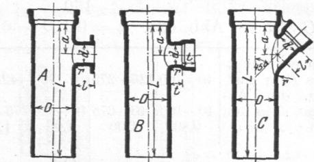
Abb. 633 bis 635. A-, B- und C-Stück zur Herstellung von Abzweigungen.
