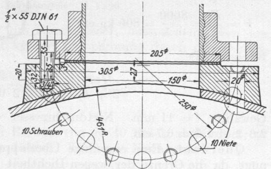
Abb. 533. Rohranschluß am Windkessel, Abb. 531, M. 1 : 10.
