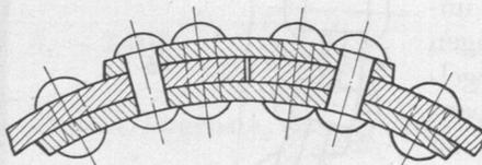
Abb. 506. Zusatzspannungen in der Überlappung.
