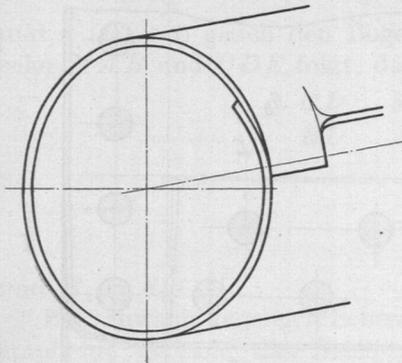
Abb. 499. Zuschärfung des mittleren Blechs an der Stoßstelle.
