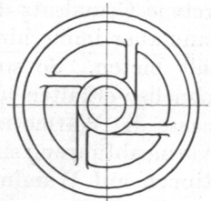
Abb. 209 und 210. Doppelsitzventil mit radial und tangential angeordneten Rippen.
