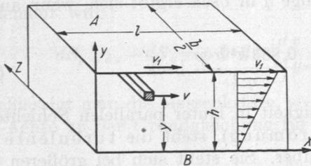
Abb. 936 b. Geschwindigkeitsverteilung in einer zähen Schicht zwischen einer ruhenden und einer bewegten Ebene.
