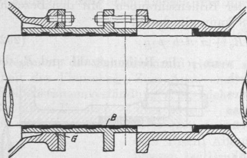
Abb. 950. Abdichtung eines Pumpenplunschers durch eine Stopfbüchse.
