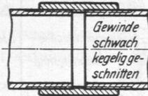
Abb. 651. Gasrohrmuffe.
