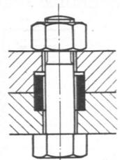
Abb. 385. Entlastungsring.
