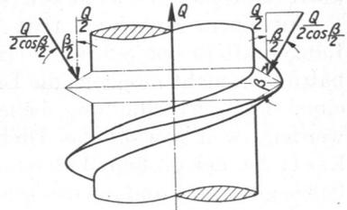
Abb. 375. Kraftwirkung an scharfgängigen Schrauben.
