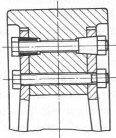
Abb. 384. Entlastung der Schraube durch kegelige Büchsen.
