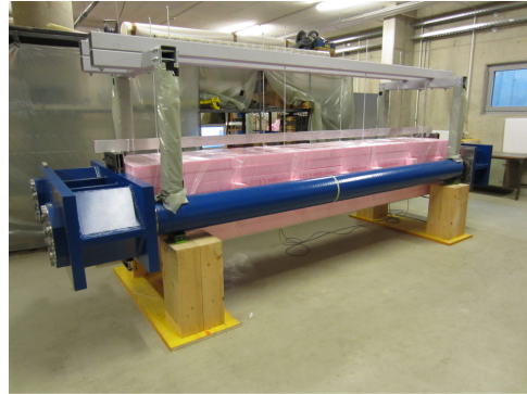
Abb. 3.9.: Versuchsaufbau der TU Graz zur experimentellen Untersuchung der Zwangspannungen in Erhärtungsphase und Nutzungszeitraum
