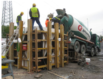
Abb. 2.1.: Probekörper zur Ermittlung der quasi-adiabatischen Temperaturerhöhung
