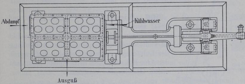
entsprechend einem Zylinderdurchmesser von 15,6 cm = gerundet 160 mm. Bei einem Hub von 0,4 wird, wenn der Antrieb von dem verlängerten Kurbelzapfen ohne Gegenkurbel aus erfolgt, eine Hebelübersetzung im Verhältnis  $0,6 : 0,4 = 3 : 2$  erforderlich.
