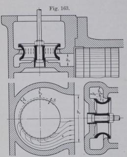
das Verhältnis os: om, das mit o bezeichnet werden möge, so wird man sich auf om beziehen können, indem der Querschnitt des Verbindungskanals dann wird = k o om. Durch Nachmessen der Höhe os in den Figuren 98 S. 145, 104 S. 154, 110 S. 161, 160 S. 244 und Division durch om findet man  $\varphi$ , bzw. = 0,89, bzw. = 0.89, bzw. = 0.78, bzw. = 0.77. Bei Auslaßsteuerungen wird o in der Regel = 1 werden. Das Produkt ko werde mit a bezeichnet.
