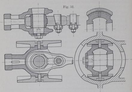
und nicht an so strenge Formen gebunden wie beim bearbeiteten Kopf. Die Übergänge der einzelnen Formenelemente können durch Abrundungen am Holzmodell verwischt werden, so daß Durchdringungslinien nicht überall in Erscheinung treten werden (Fig. 52).
