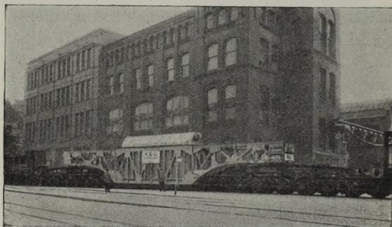
Transport des 120000 kVA — Transformators im Käfigwagen
