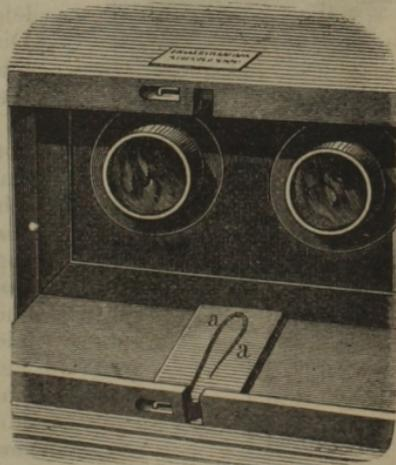
derselben ausdehnt, so daß er stets die beiden Hälften der Camera vollständig trennt. Er läßt sich, falls man nur ein Objectiv anwenden will, leicht herausnehmen. Die Cassette faßt eine Platte von  $7\frac{1}{4} \times 4\frac{1}{2}$  Zoll und enthält einen Rahmen, um auch kleinere Platten einlegen zu können. Die Platten ruhen auf Silberdraht, der in den vier Ecken
