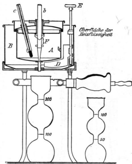
Fig. 31 I. Englersches Viskosimeter (Durchschnitt).
