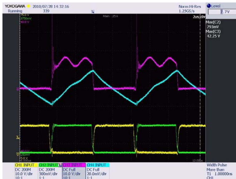
Abbildung 16: Strom und Spannungsverhältnisse beim Schalten
