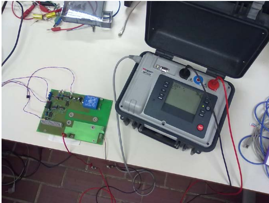
Abbildung 35: Isolationswiderstandsmessung der Schutz- und Überwachungsplatine
