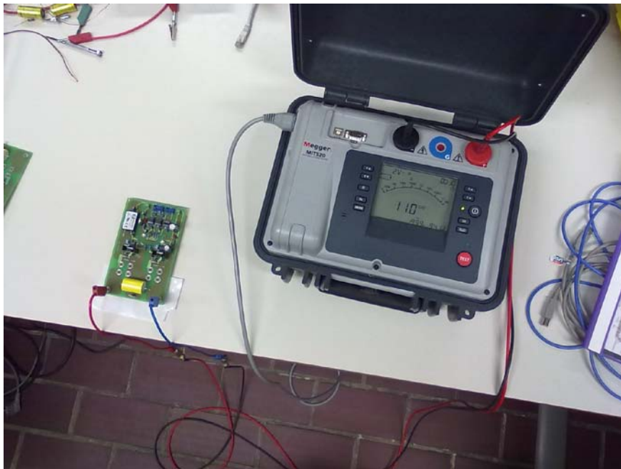
Abbildung 37: Isolationswiderstandsmessung der Halbbrückenplatinen und Ergebnis der Messung
