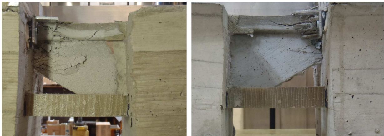
ABBILDUNG 22: VERSAGENSBIKD MV1-3 (LI) UND MV1-4 (RE)
