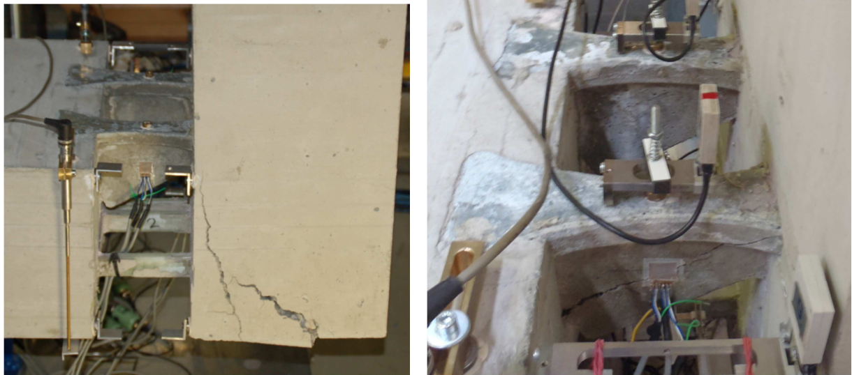
ABBILDUNG 26: VERSAGENSBIKD MV3-1 (LI) UND MV3-2 (RE)
