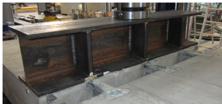
ABBILDUNG 17: LASTEINLEITUNG BEI 3 ELEMENTEN
