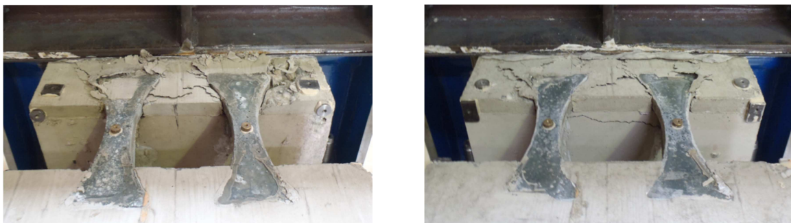
ABBILDUNG 27: VERSAGENSBIKD MV3-3 UND MV3-4
