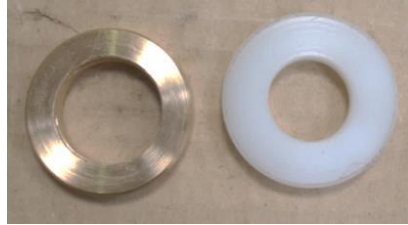
Abbildung 5.22 Stauscheiben als Ersatz für die Wellendichtringe
