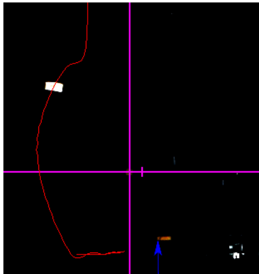
Abbildung 5.30 Einzelbild der Videoaufzeichnung mit Trajektorie der Prüfmasse
