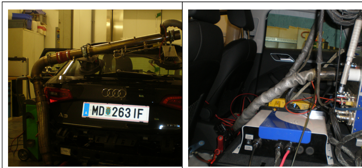
Abbildung 6-2: PEMS - Messaufbau, Fahrzeug 2
