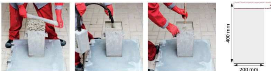
Bild 85 Konsistenzprüfung des Frischbetons durch Ermittlung des Verdichtungsmaßes 479
