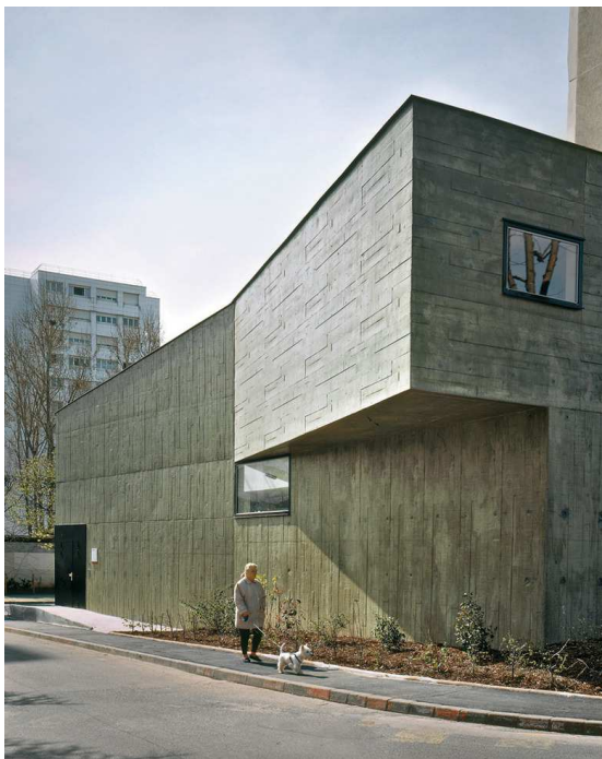
Bild 11 Raue Sichtbetonfläche durch die Anwendung von Strukturmatrizen 124
