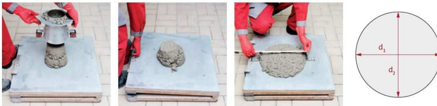
Bild 84 Konsistenzprüfung des Frischbetons durch Ermittlung des Ausbreitmaßes 476
