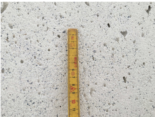
Bild 171 Zunahme des Porengehalts und der Porengröße
