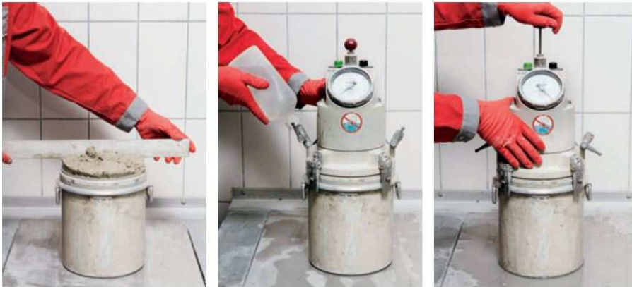
Bild 86 Bestimmung der Frischbetonrohichte und des Luftgehalts 483
