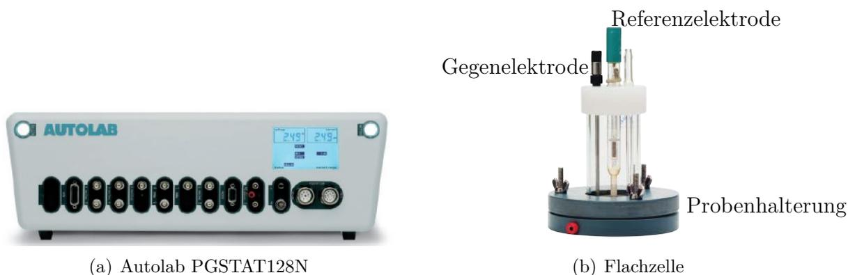
Abbildung 3.1: Potentiostat & Flachzelle [64, S. 4 & 32]
