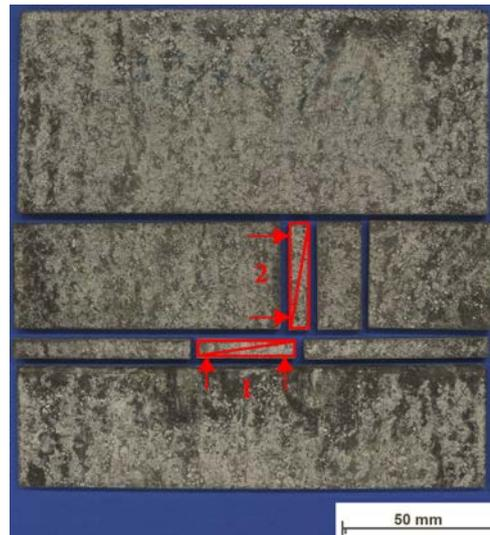
Abbildung 4.15: Probenentnahme für die Versuchskörper der Korrosionstruhe
