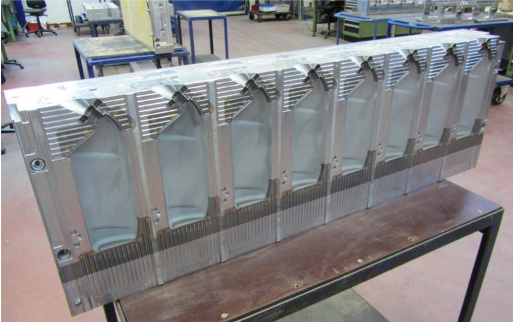
Abbildung 1.1: Blaswerkzeug der Firma Alpla Verpackungstechnik
