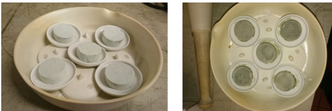
Abbildung 21: CaBa- Tabletten (vor und nach dem Brennvorgang)
