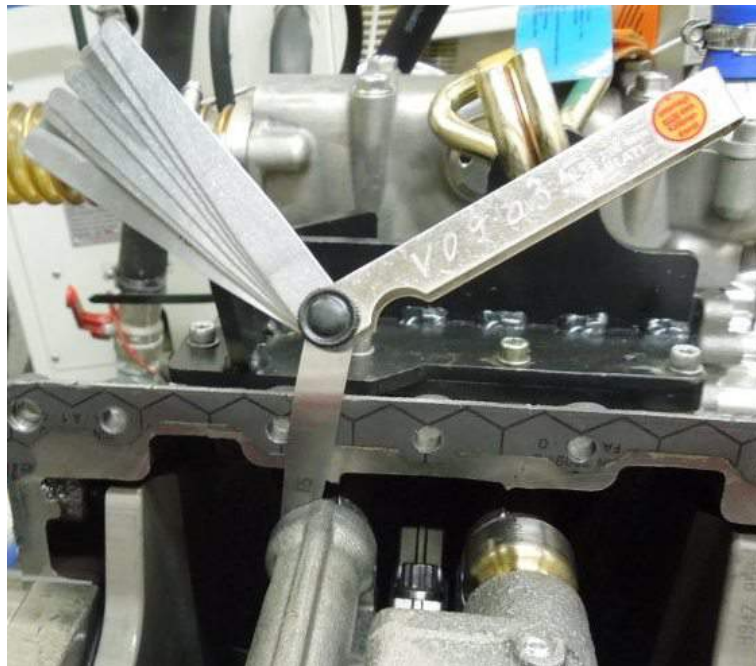
Abbildung 3.18.: Verspannung des Massenausgleichssystems
