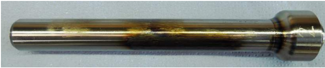
Abbildung 4.3.: verriebene Führungsstange der Reibpaarung geschliffene Führungsstange und Graugussbuchse
