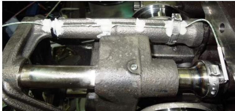
Abbildung 3.8.: Temperaturmessstelle an den Führungsstangen
