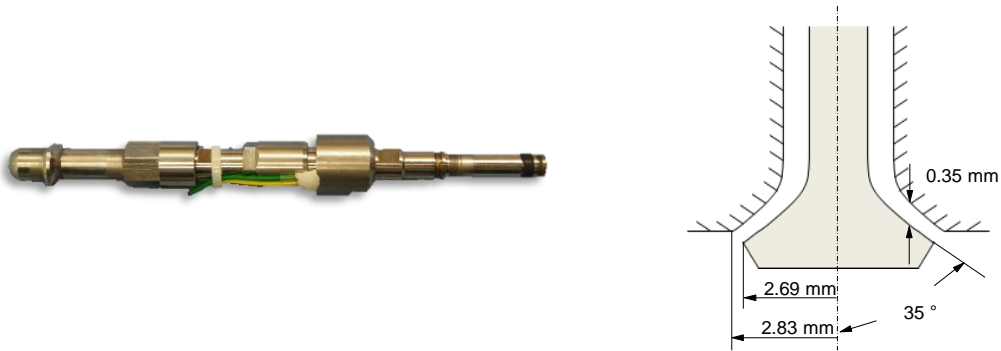
Bild 5.2: Verwendeter Erdgasinjektor und angenommene Düsengeometrie
