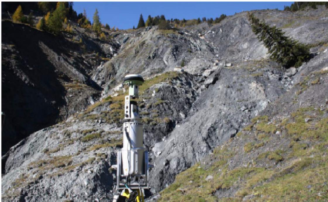
*Abbildung 46 Aufnahme von Daten mittels Scanner und RTK-GPS (Liu, 2014b)*
