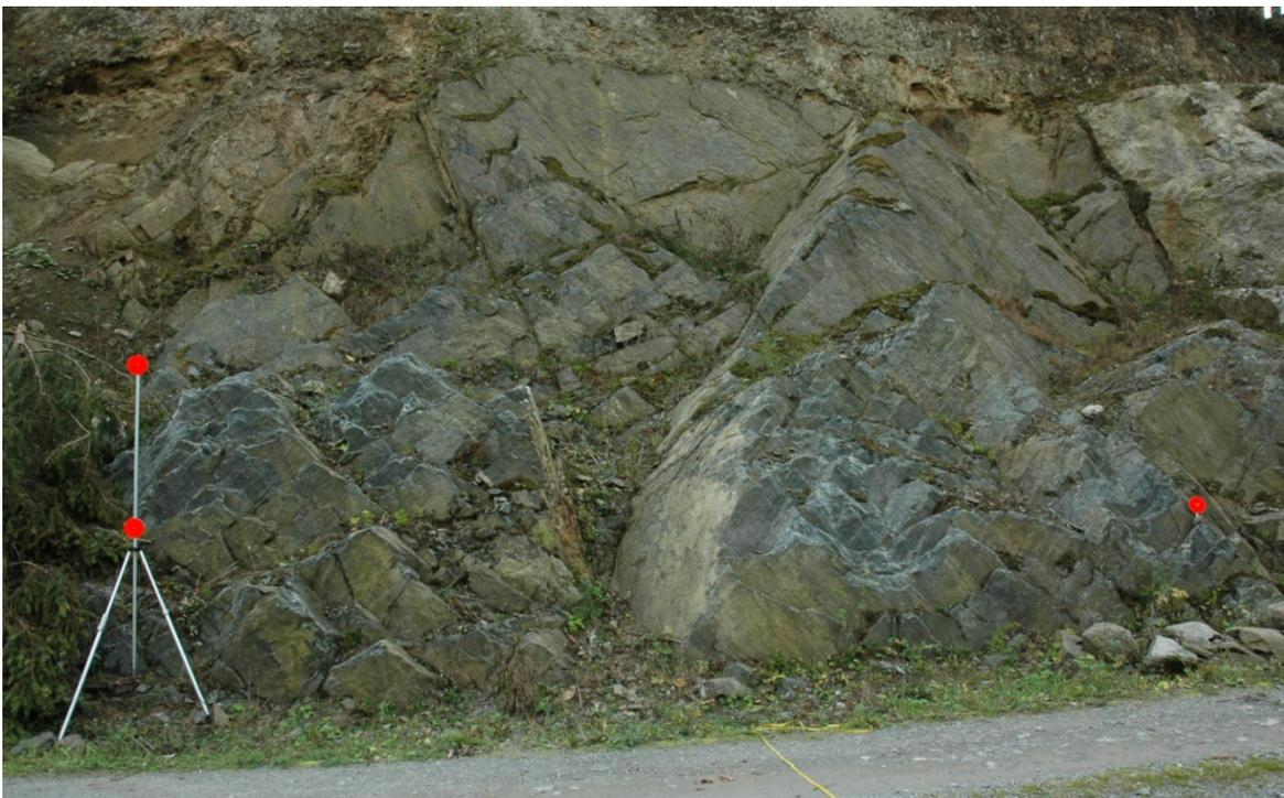
*Abbildung 45 Anordnung für eine Aufnahme für die Photogrammetrie (Liu, 2013)*
