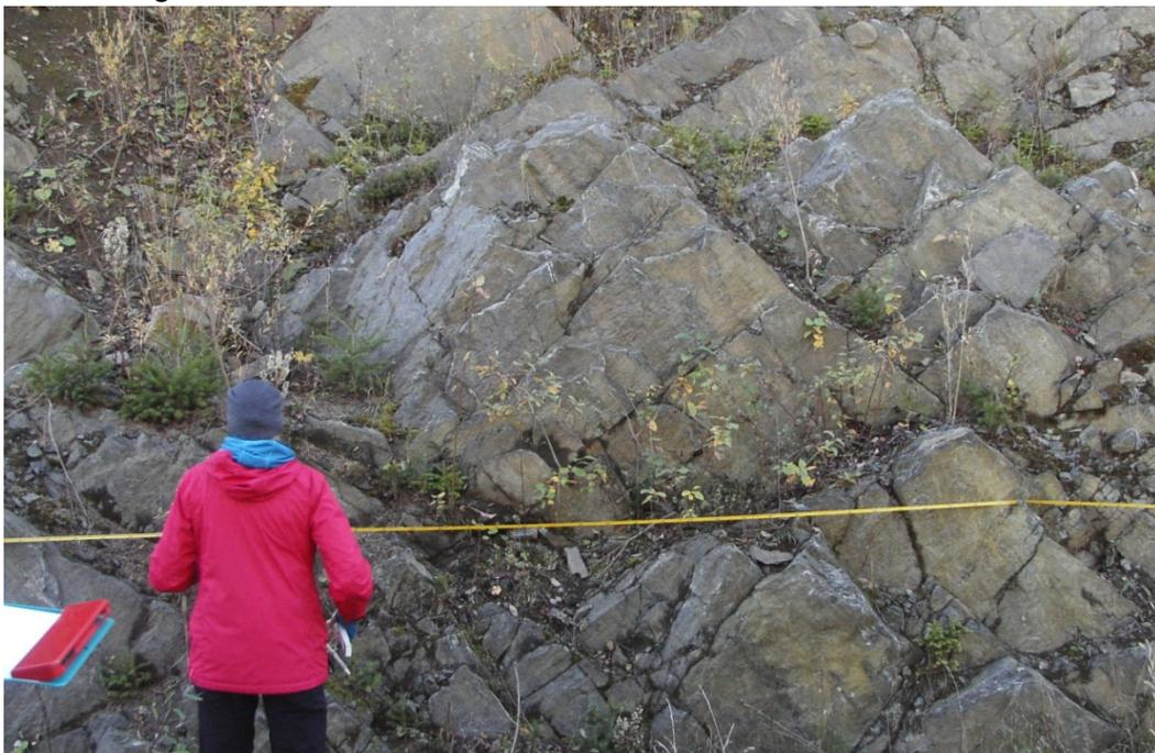
*Abbildung 41 Scanline über den Aufschluss*
