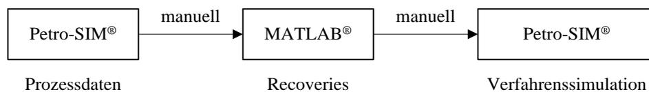
Abb. 6-2: derzeitiger Datenfluss zur Simulation des Adsorptionsprozesses
