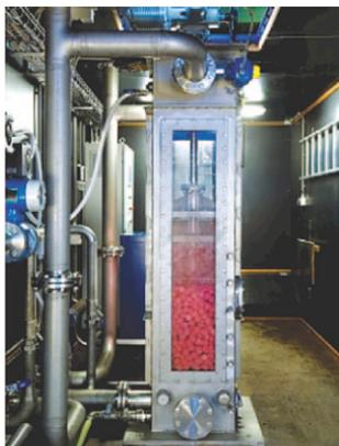
Testcontainer mit Fuzzy Filter® Typ 1 für Pilotversuche
