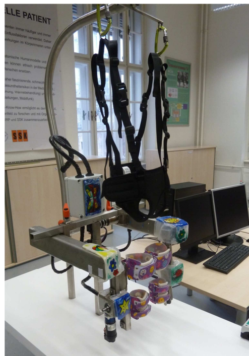
Abbildung 1: Entwickelter Prototyp zur Lokomotionstherapie von Kleinkindern [10] [12]
