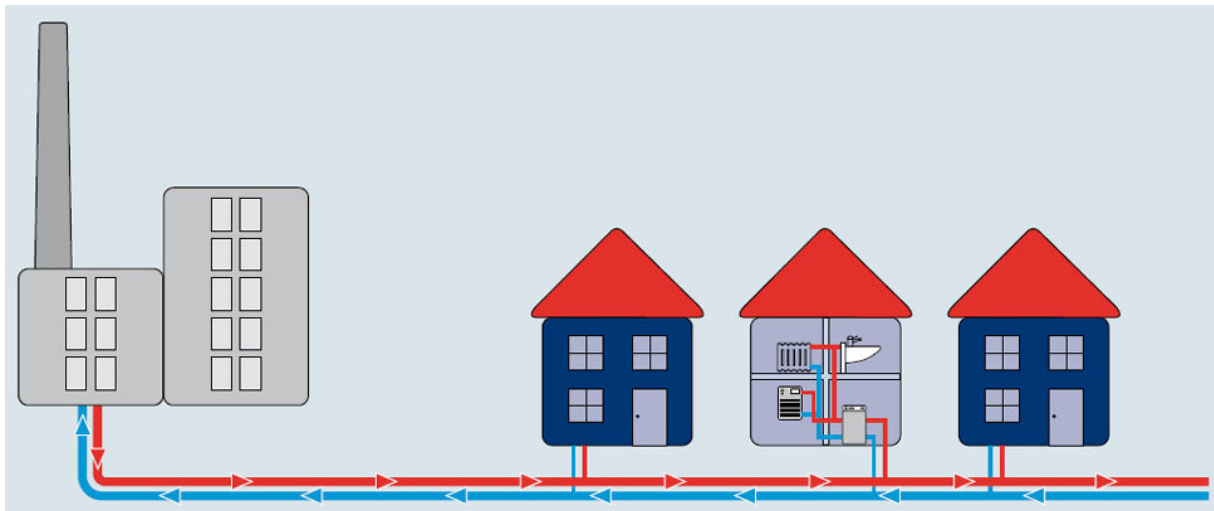
Abbildung 3: Funktionsprinzip der Fernwärme [11]
