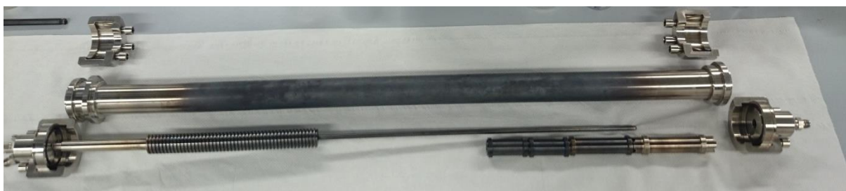
Abb. 3-4: Foto von Rohreaktor inkl. seiner Bestandteile im demontierten Zustand
