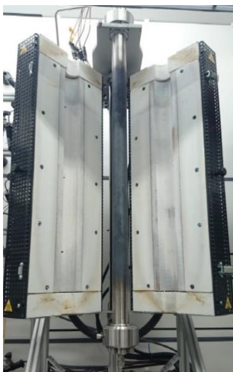
Abb. 3-3: Foto von Reaktor mit geöffneten Heizmantel; Gasströmungsrichtung von oben nach unten
