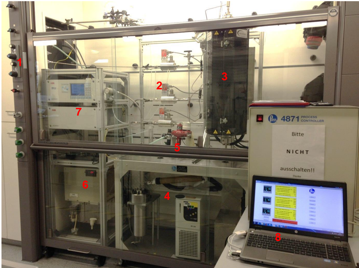
Abb. 3-2: Versuchsanlage (1: Sperrventile; 2: MFC; 3: Rohrreaktor; 4: DR-WT mit Kondensatbehälter; 5: BPR; 6: MGK; 7: GA; 8: PC mit SCADA)
