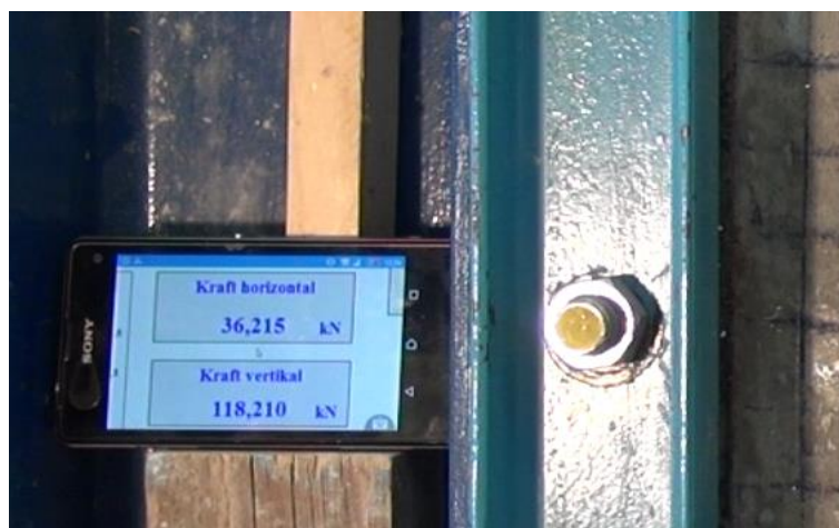
Abbildung 3.1: Übertragung der Messwerte auf ein Smartphone
