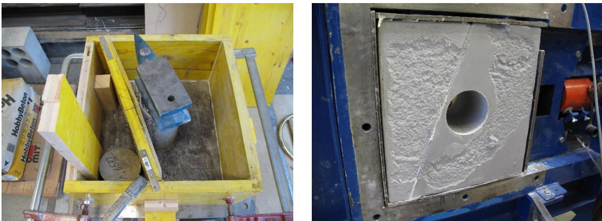
Abbildung 7.1: Vorbereitete Schalung für den Einbau des Modells (links) und unebene Modelloberfläche (rechts)
