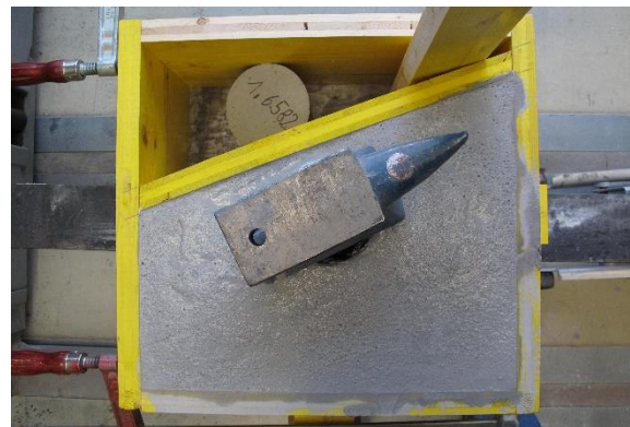
Abbildung 5.1: Geometrie (Maße in [cm]) und Schalung nach dem Einbau des ersten Modellteils
