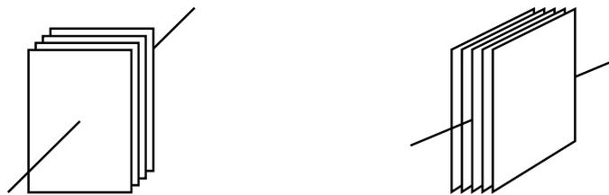
**Abbildung C:** Die *linke* Abbildung stellt die konventionell- oder radial-geblechte Bauweise dar. Die *rechte* Abbildung zeigt die axial-geblechte Bauweise.
