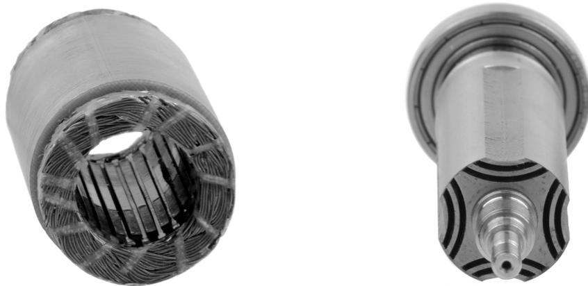
**Abbildung 5.2:** Die *linke* Abbildung stellt den Stator, die *rechte* den Rotor der synchronen Reluktanzmaschine dar. Aus: Lang 2015 (Änderungen durch den Autor).
