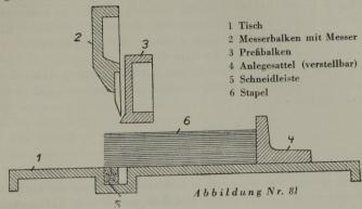
hierauf durchgeschnitten wird. Nach dem Schnitt geht das Messer automatisch hoch, worauf anschließend die Pressung aufgehoben wird. Es gibt verschiedene Maschinenausführungen mit festem, fahrbarem oder drehbarem Hintertisch sowie solche mit mehreren Messern.
