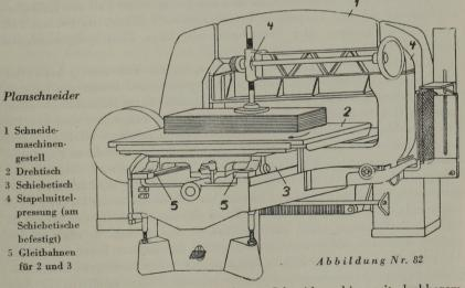
Als Planschneider bezeichnet man eine Schneidmaschine mit drehbarem Hintertisch, die zum vierseitigen Beschnitt großer Stapel dient. Dabei ist eine Hilfspressung auf der Stapelmitte vorgesehen, um ein Verrutschen und Drehen zu vermeiden. Abbildung Nr. 82 zeigt eine Ausführung (K. Stegemann).
