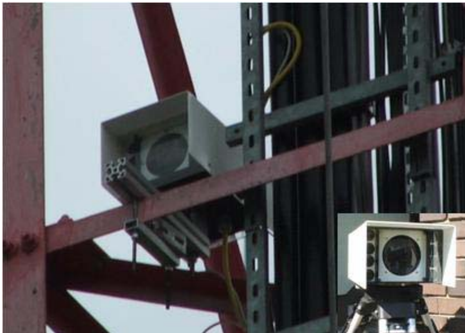
Abb. 7.2: Montagesituation des FSO Systems am Masten, Eigenentwicklung der TU Graz (Detail, rechts)
