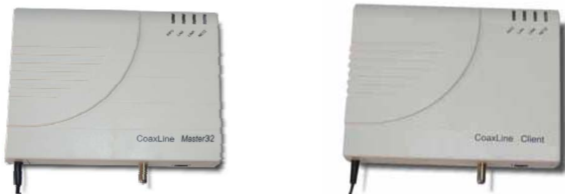
Abb. 3.1: Datenblattauszug der Firma Elcon Systemtechnik, MoCa Master (links), MoCa Client (rechts)[94]
