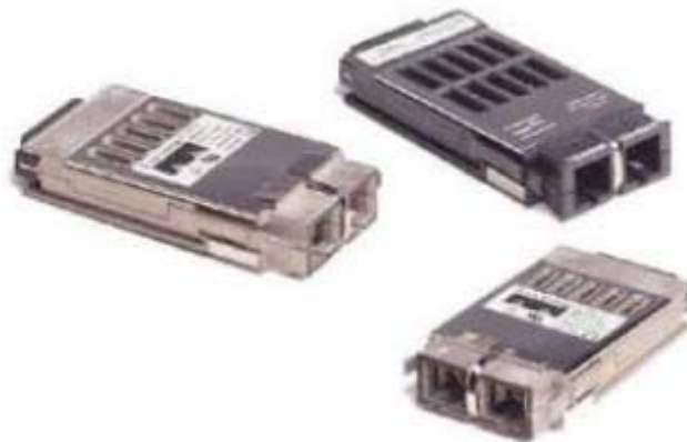
Abb. 8.12: Datenblattauszug der Firma Cisco Systems, Beispielhafte Ansicht von 1GB Transceivern [3]
